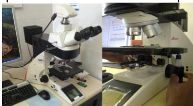
Figura 2 - Microscópio ótico de luz refletida do tipo Leica DM4000 M-1
