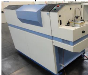
Figura 1 - Equipamento de análise química (Espectrometria de Emissão Ótica)
