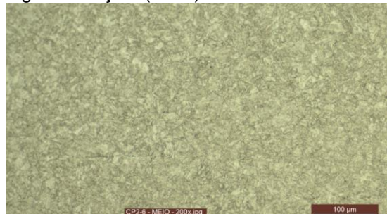
Figura 8 - Aço 2 (P110) - Martensita revenida
